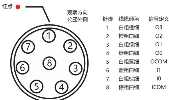
图45 GPIO定义
